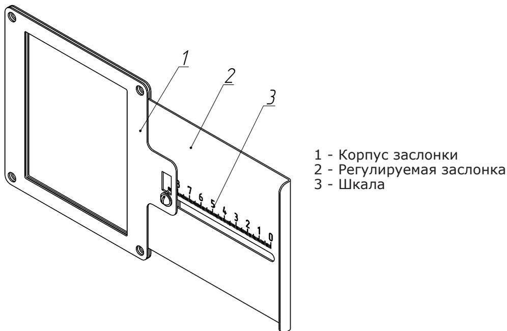
Рис.15 Заслонка вентилятора.
