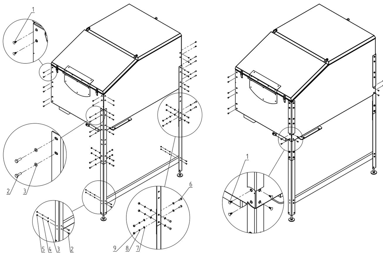
Установка на двухшнековый механизм
