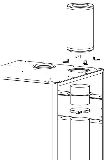
Если WALLCON X-treme будет эксплуатироваться в запыленной окружающей среде, то котел должен быть оборудован фильтром входящего воздуха. Этот дополнительный фильтр должен регулярно проверяться.
