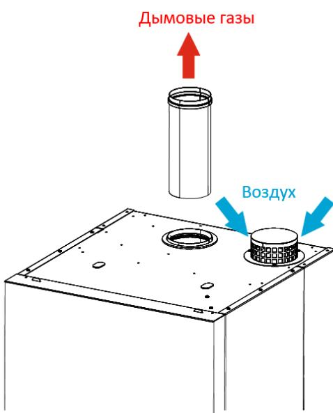
Если необходимо использовать соединение дымохода типа B23, следует использовать переходник для всасывания чистого воздуха, а отработанный газ следует отводить во внешнюю среду через трубу Ø80 мм.
