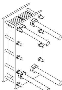
Пластинчатый теплообменник – это элемент системы, который физически разделяет систему отопления и водогрейный котел на первичный и вторичный контуры.
