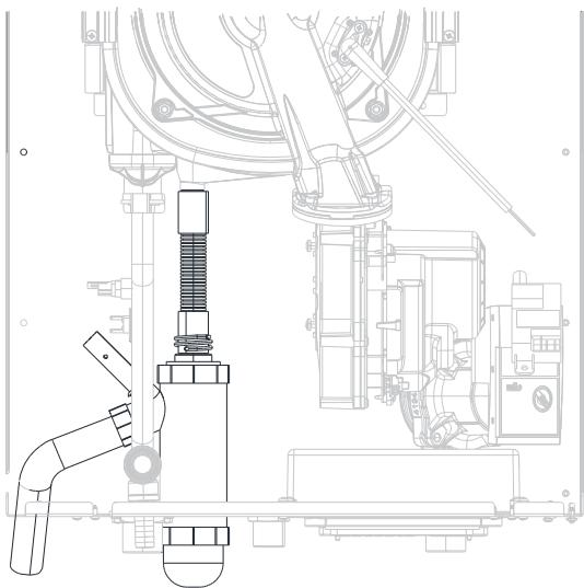
Конденсат, образующийся в процессе сгорания, сливается в систему канализации через сифон и дренажный шланг. Подключение дренажного шланга к системе канализации должно быть выполнено с созданием постоянного уклона и разрывом потока. В качестве альтернативы подключить сливной шланг к устройству нейтрализации конденсата.
