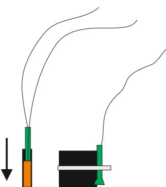
В погружную гильзу вначале опускается датчик центрального отопления (датчик ЦО), а за ним датчик термозащиты (термик). Как вариант, допускается установка датчика термозащиты на патрубке подающего трубопровода котла (до гайки подключения), при этом, прижатие его к патрубку должно выполняться металлическим хомутом. Добавление каких-либо жидкостей в погружную гильзу запрещено!
