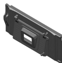
Рис. 3. Регулировочная дверца подачи первичного воздуха
