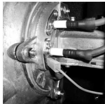
Высоковольтная клеммная коробка моделей серии impact-W
