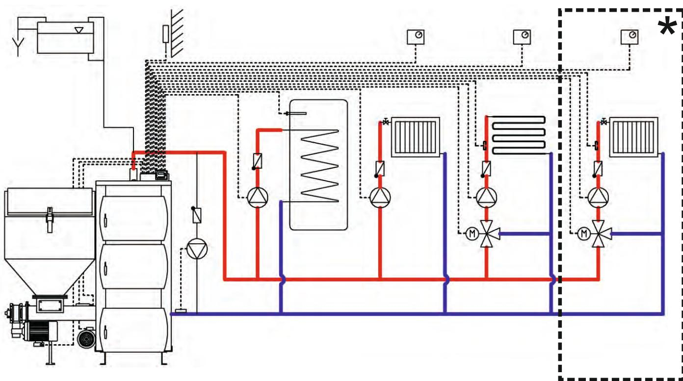
\* Независимое управление смесительным клапаном с использованием контроллера HT tronic Z3D (опция)
