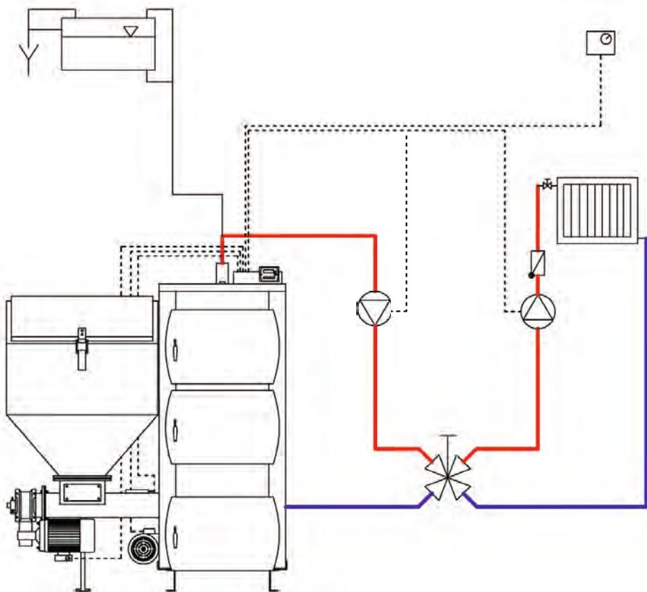
**Исполнение с использованием трехходового смесительного клапана и насоса на подмесе обратной линии**
