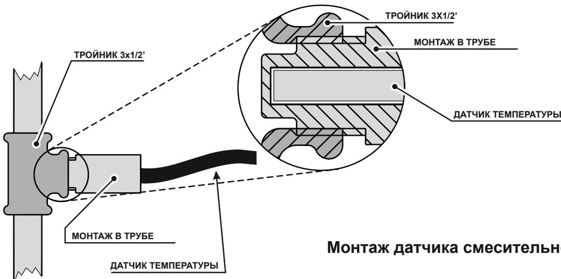
Монтаж датчика смесительного клапана
