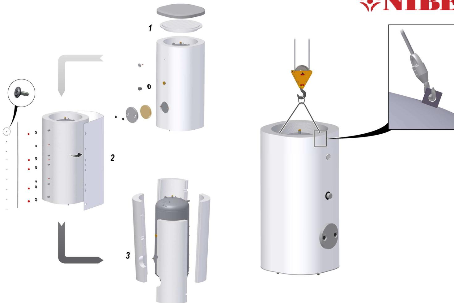
Рис. 5 Демонтаж корпуса
