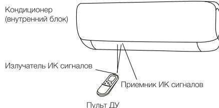
Когда вы используете пульт ДУ, всегда направляйте излучатель ИК сигналов прямо на приемник сигналов на внутреннем блоке. Для нормальной работы кондиционера не устанавливайте пульт ДУ в следующих местах:
