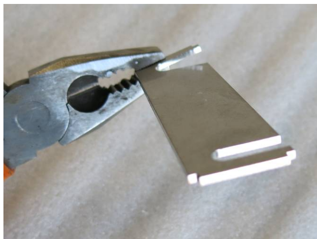
Рис. 34 - Отгибание краев полки
