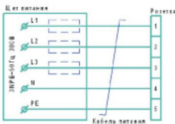
Рис. 3 Схема подключения розетки к стационарной сети
