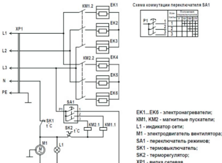
Рис. 1.2 Схема электрическая Т-18380
