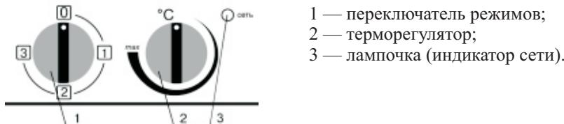
Рис. 2. Панель шасси
