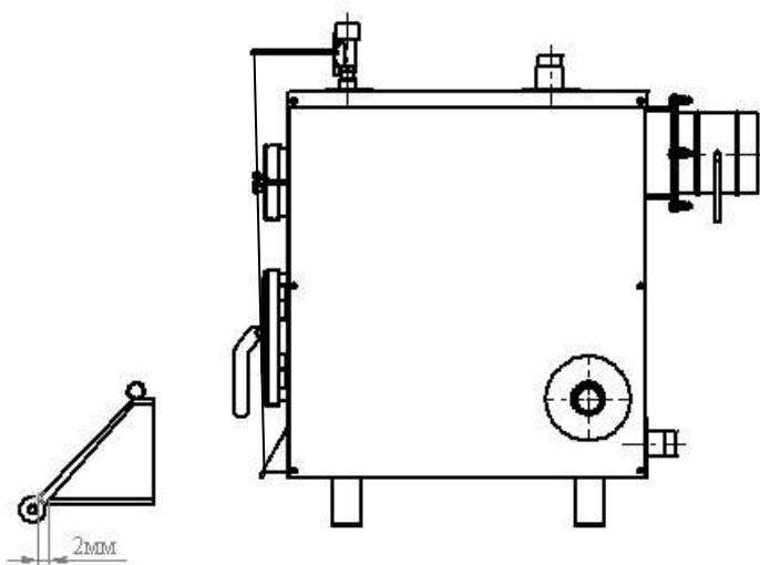
Рисунок 8 - Настройка цепи регулятора
