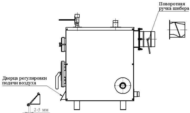
Рисунок 7 – Положение шибера и дверки регулировки подачи воздуха в экономном режиме
