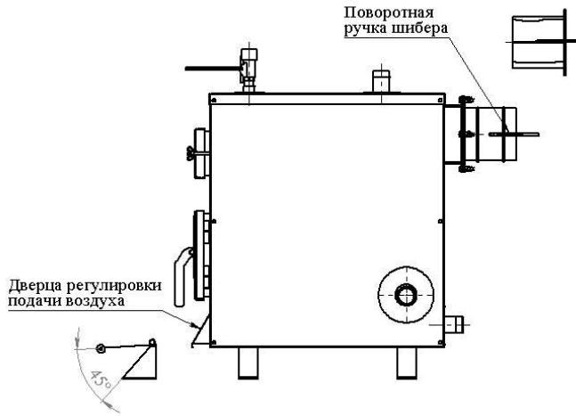
Рисунок 5 - Положение шибера и дверки регулировки подачи воздуха при растопке
