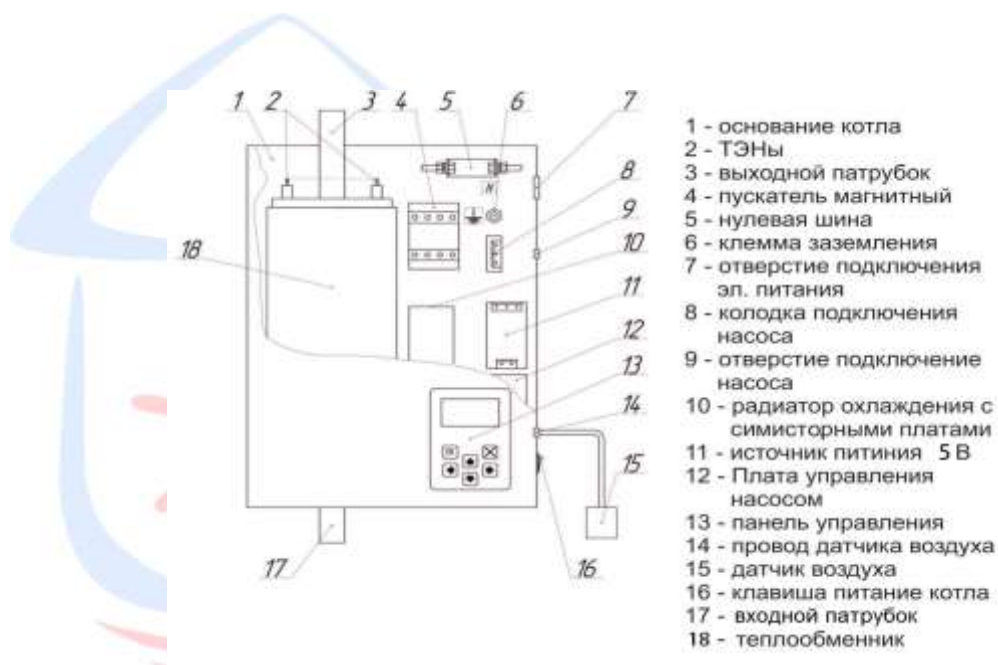
Рисунок 1. Устройство отопителя РЭКО серии П
