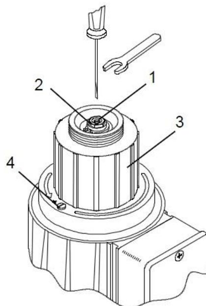
**Процедура регулировки газового электромагнитного клапана с медленным открытием (Krom Schroder)****Настройка расхода:**
