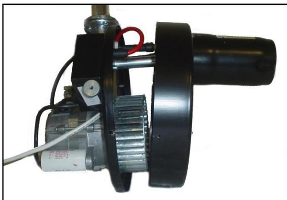
3- Ослабьте стопорный винт держателя электродов и отрегулируйте электроды зажигания и ионизации, как показано на рисунке. Убедитесь, что электрод ионизации не контактирует с диском дефлектора, а потом затяните винт.
