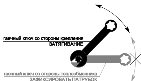
Рис. 5. Подключение к системе подачи теплоносителя
