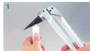
1 Смажьте конус инструмента графитовой смазкой Uponor
